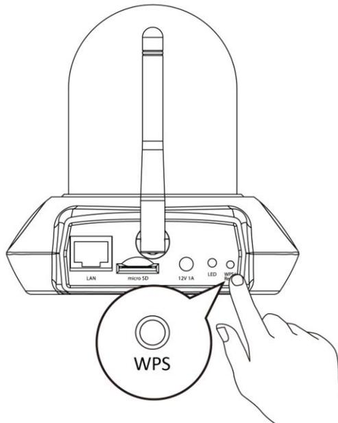
2. Warten Sie, bis die Netzwerkkamera neu gestartet wird. Die Kamera ist bereit, wenn die LED **langsam rot blinkt**.
