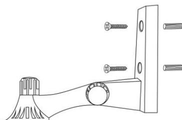
2. Befestigen Sie die Unterseite der Netzwerkkamera am Montageständer und ziehen Sie sie wie unten dargestellt fest:
