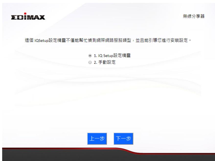
2. 使用網路線連接 BR-6208AC 的藍色網際網路連接埠及您數據機的 LAN 連接埠，然後點擊「下一步」。
