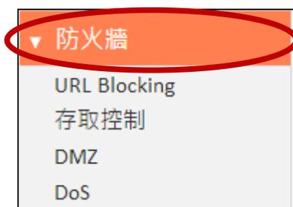
「防火牆」功能提供對於 URL 封鎖、存取控制、DMZ 和 DoS 功能的設定，以改善您無線網路的安全性。
